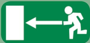
Ce pictogramme doit être utilisé pour indiquer le chemin à suivre pour atteindre une sortie de secours.
